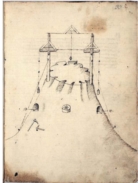
Fig. 4. Taccola, tracciamento di una galleria con l'uso di archipenzoli per individuarne la pendenza (f. 60r; Palatinus 766, Firenze, Biblioteca Nazionale Centrale).
